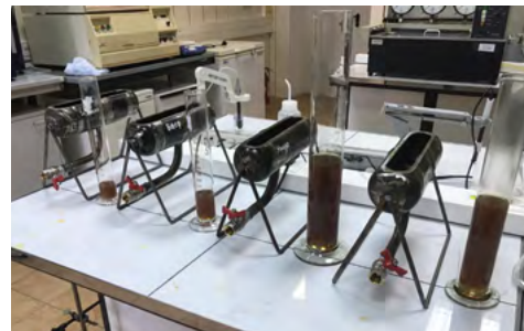
Лабораторные испытания методики определения сливаемости конденсата с использованием имитаторов вагон-цистерн
