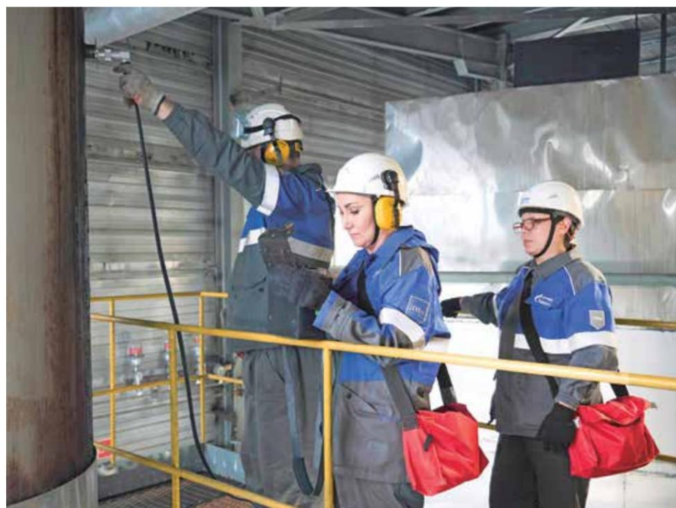
Процесс отбора проб газоанализатором дымовых газов «Полар»
