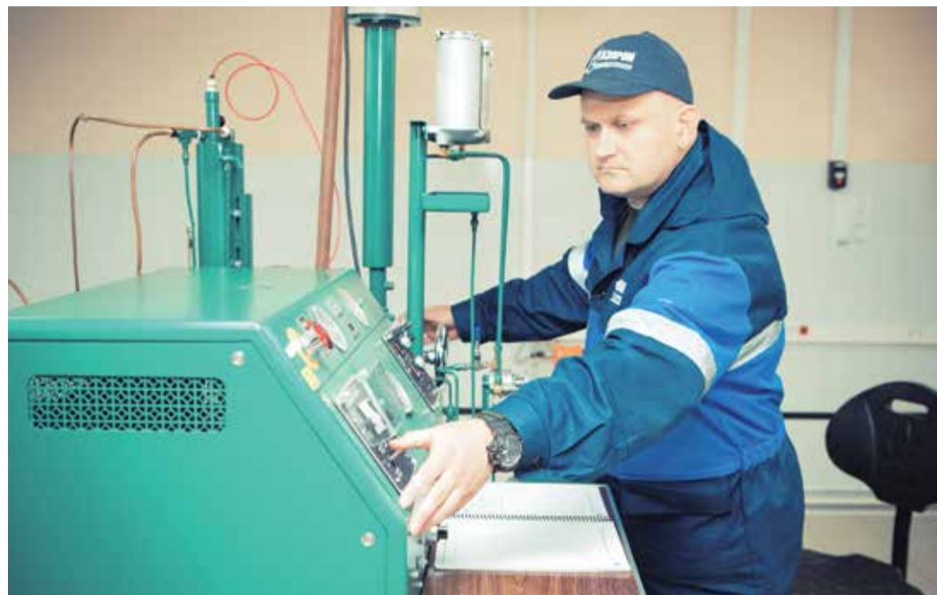
Определение октанового числа автомобильного бензина в ЦЗЛ Сургутского ЗСК
