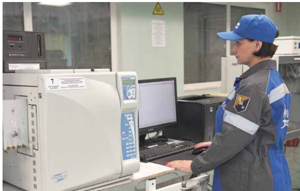
Работа лаборанта с хроматографическим комплексом «Гелий-микро»
